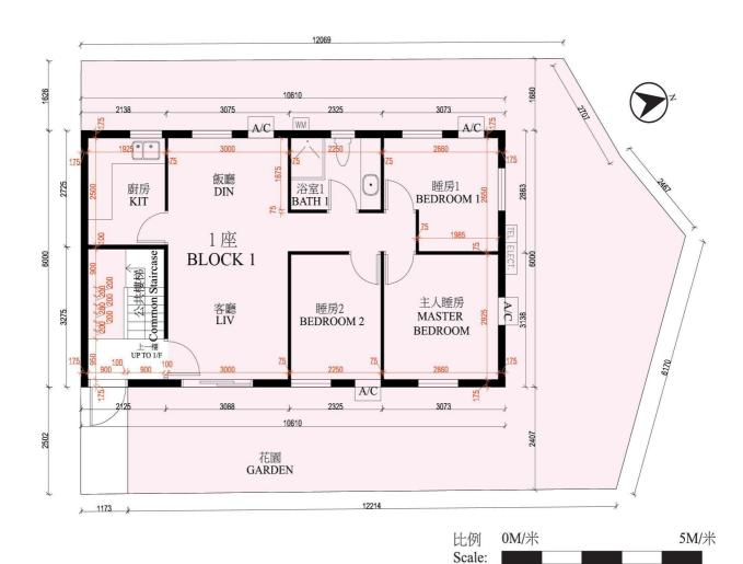
備註:平面圖之尺規所列數字以毫米標示之建築結構尺寸。
