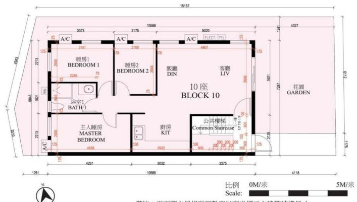
備註:平面圖之尺規所列數字以毫米標示之建築結構尺寸。
