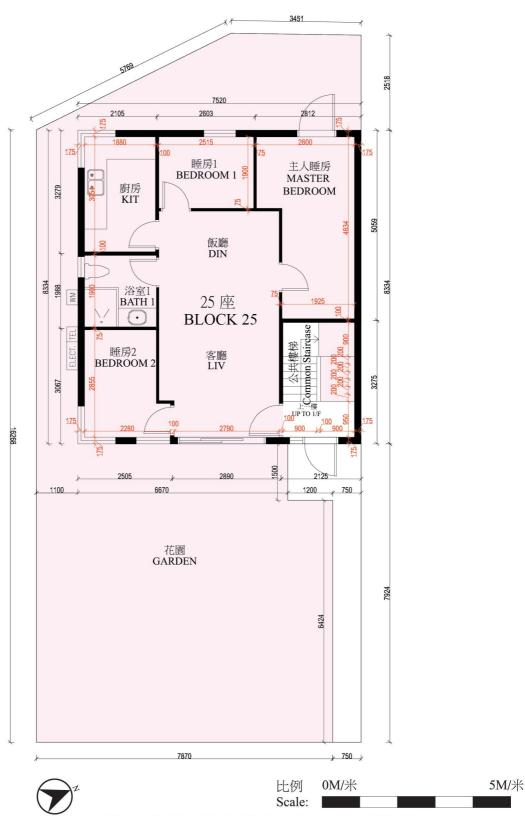
備註:平面圖之尺規所列數字以毫米標示之建築結構尺寸。
