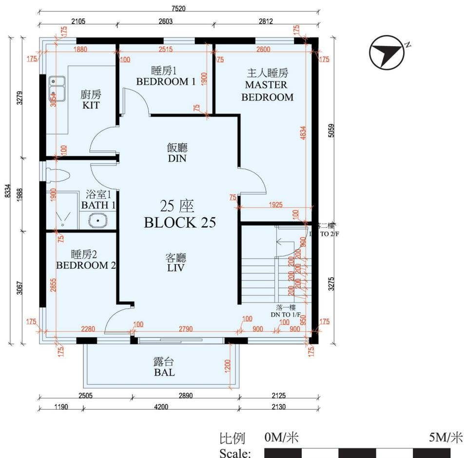
備註：平面圖之尺規所列數字以毫米標示之建築結構尺寸。
