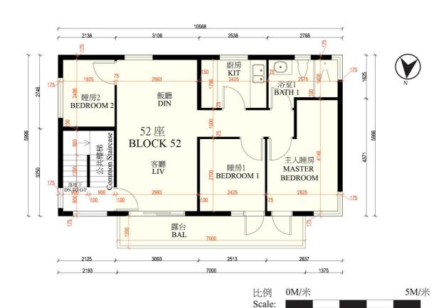
備註:平面圖之尺規所列數字以毫米標示之建築結構尺寸。
