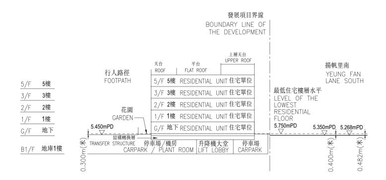
MANSION C - CROSS-SECTION PLAN B-B 低座C座 - 横截面圖B-B
