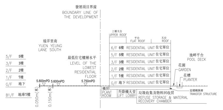
MANSION D - CROSS-SECTION PLAN B-B 低座D座 - 横截面圖B-B
